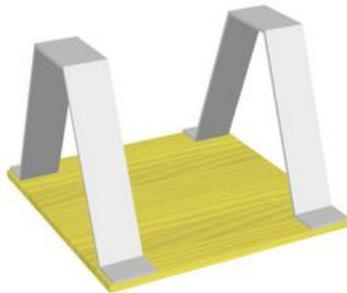
Опора, предназначенная для установки качалок в грунт с последующим бетонированием.
